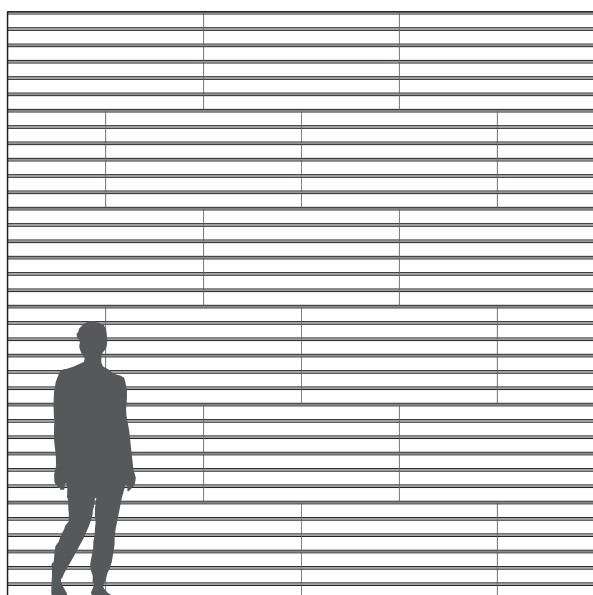
Troldtekt v-line 1way 6 monteret i vandret halvforbandt.
