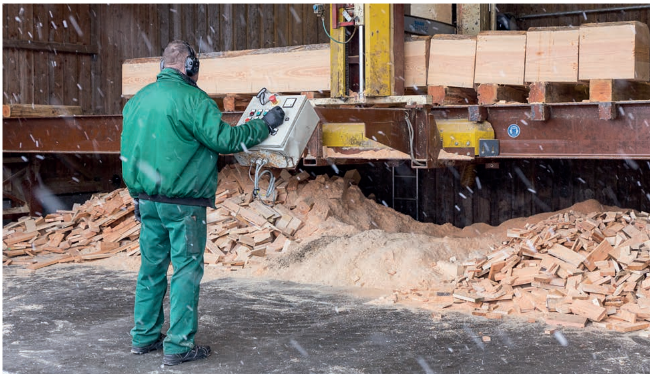
▲ En stor egetræsstamme bliver skåret i blokke på en af savværkets store save.
